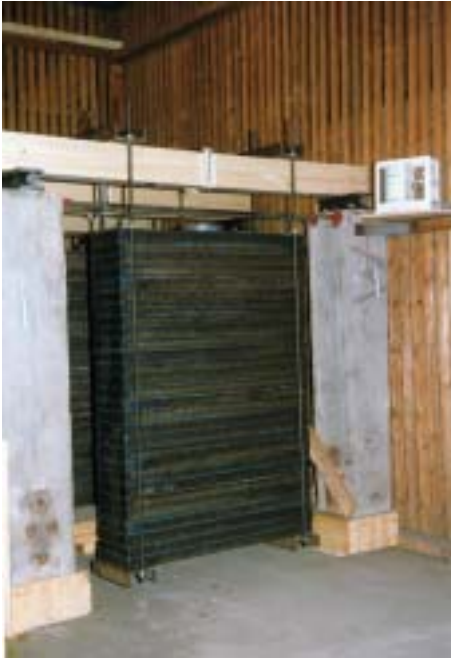
Bild 2: Prüfstand mit einem der Träger, belastet mit m = 2800 \text{ kg}
