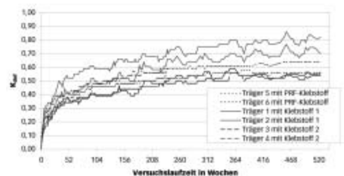
Diagramm 2: Verformungsbeiwerte k_{\text{def}} der Prüfträger über einen Zeitraum von 10 Jahren
